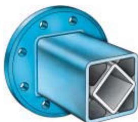
Fig. 9 Brida soldada en lateral
