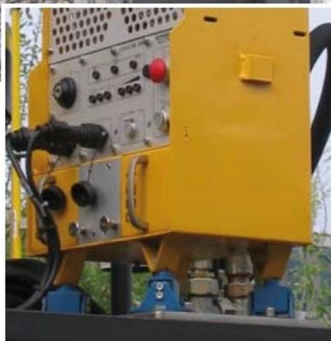
Suspensión antivibrante tipo V-27 en sistema luces emergencia en carro de ferrocarril.
