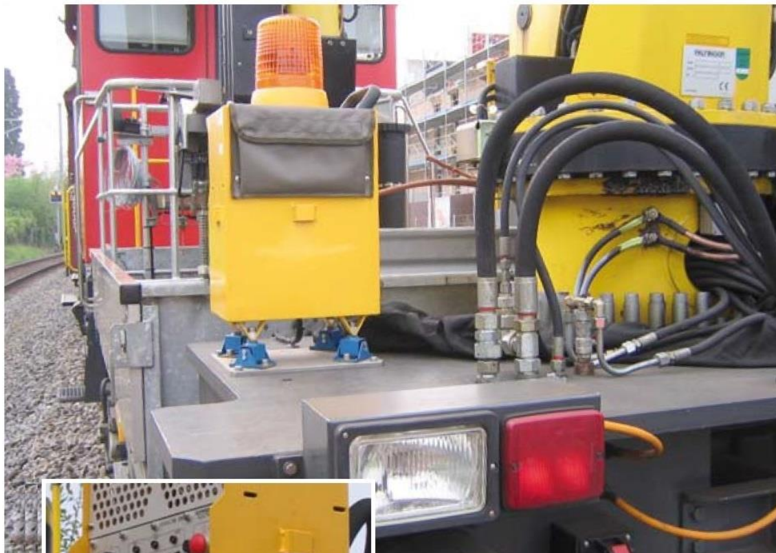
Suspensión antivibrante tipo V-27 en sistema luces emergencia en carro de ferrocarril.
