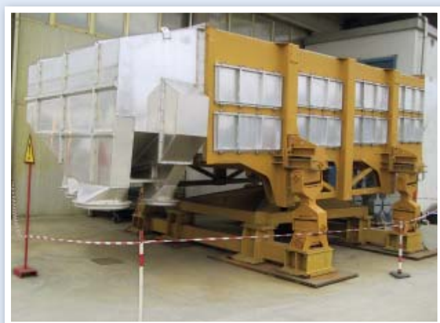
Clasificadora de virutas de madera equipada con 8 juntas universales del tipo AK 100-4
