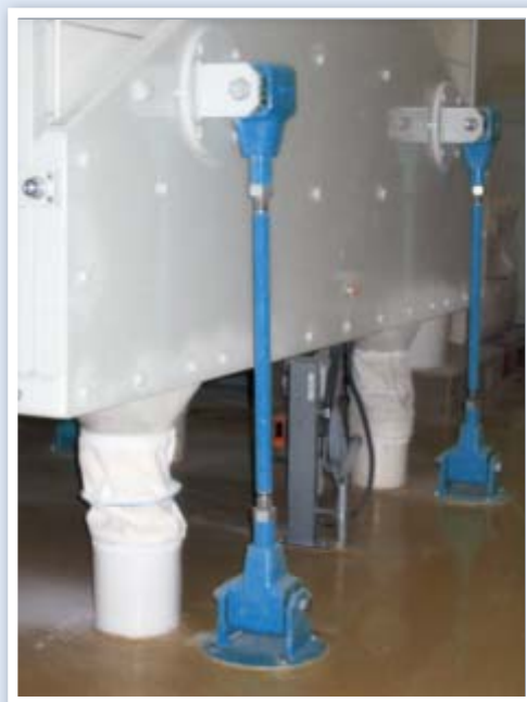
Tamiz giratorio de oscilación libre para la selección de harinas equipado con 8 elementos del tipo AV 38
