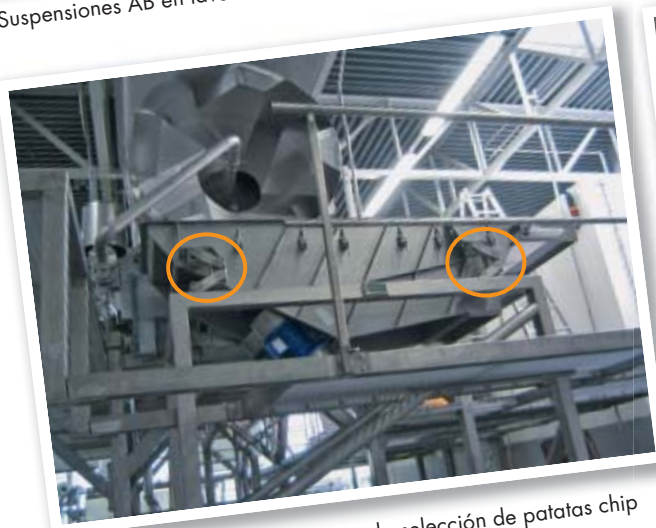
Suspensiones AB en lavadora-escurreadora de vegetales
