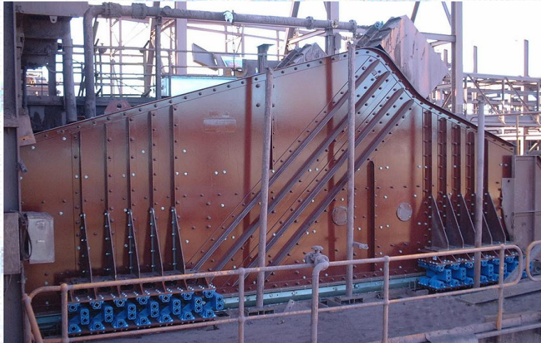
Harnero Ludowici 12' x 24' montados en soportes Rosta tipo AB-50-2-T.
