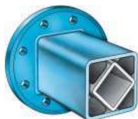
Fig. 9 Brida soldada en lateral
