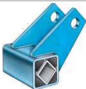
Fig. 7 Palanca doble soldada
