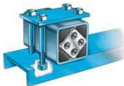
Fig. 8 Puente-abrazadera sobre la pieza
