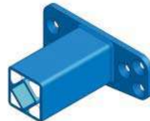
Estructura soldada, tipo de goma «Rubmix 50» para bisagra en rampa de autobús
