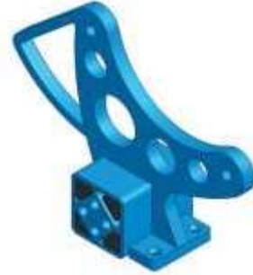
Elemento diseñado para la suspensión de la rueda delantera en sillas de ruedas
