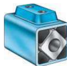
Fig. 6 Doble placa soldada y roscada
